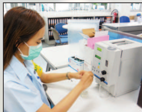
รูปภาพแสดงกิจกรรมการตรวจวิเคราะห์ค่าไขมันในน้ำเสียด้วยเครื่องวิเคราะห์อัตโนมัติ โดยทำการวิเคราะห์ทุกวัน จันทร์-พุธ-ศุกร์ ของสัปดาห์
